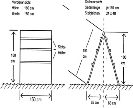
Die Schrägwand besteht aus zwei am oberen Teil verbundenen Kletterwänden von 150 cm Breite und 191 cm Höhe. Am Boden stehen diese beiden Wände soweit auseinander, dass die senkrechte Höhe 180 cm ergibt. Die ganze Fläche der Schrägwand muss mit einem rutschfesten Belag versehen sein. An den Wänden sind in der oberen Hälfte je 3 Steigleisten 24/48 mm angebracht. Alle Hunde einer Prüfung müssen die gleichen Hindernisse überspringen.
